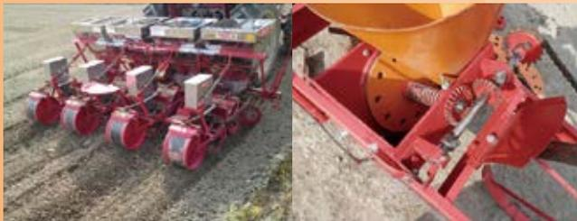
図 1. トラクターに取り付けられた播種機
