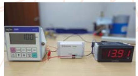
図4. 酸化還元電位計 (ORP) 及びデジタルメータとの接続事例
