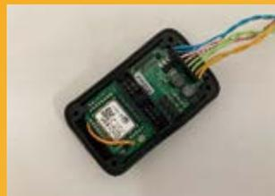
図 4. LED カラーコーンに内蔵した EnOcean 受信装置
