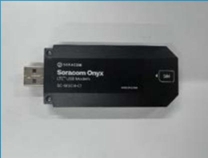
ゲートウェイにはSoracom社のLTE USB Dongleが取り付けられており、ゲートウェイから直接クラウドサーバーに受信したデータを送信することができます。LTE回線を別途利用することには、2つのメリットがあります。1つは、客先のネットワークを利用する必要がないため、導入のハードルが下がることです。もう1つは、Soracom Napterというサービスを利用することで、ゲートウェイにセキュアにリモートアクセスできることです。
