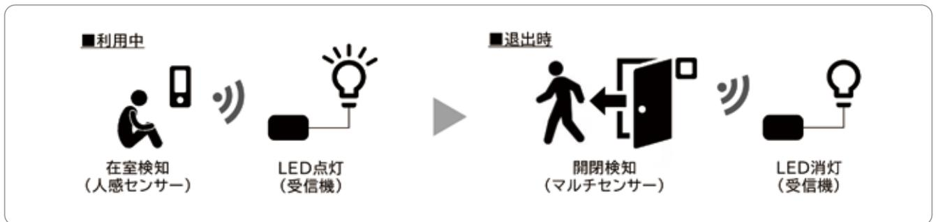
図6 点灯・消灯仕組みイメージ
