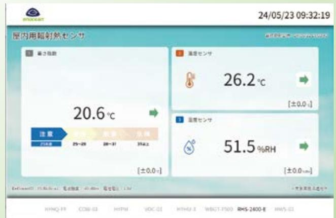
図4 輻射熱センサー表示画面イメージ
