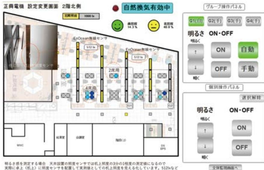
明るさを測定する場合、天井設置の照度センサーでは机上照度の3分の1程度の測定値になるので、実際に机上(机上)に照度センサーを配置して実測値としての机上照度を算出しています。512lxなど
