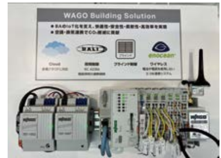
WAGO セミナールームで使用している コントローラのモジュール構成
