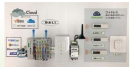
空調システムとの連携で使用している コントローラのモジュール構成
