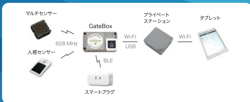
設定するだけで使える多目的コントローラー・ゲートウェイ
