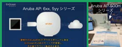
図1 Aruba Networking 社 AP+EnOcean USB ドングルによる EnOcean 送受信対応
