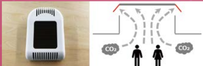
図1 CO 2 センサーを用いた換気窓操作
