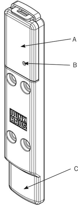
A = Batteriefach, B = Anlerntaste, C = Magnet-Kontaktfläche
