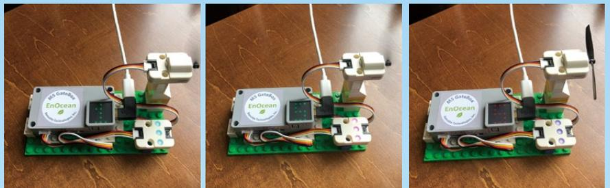
図 3. LED ユニットとファン・ユニットの動作確認
