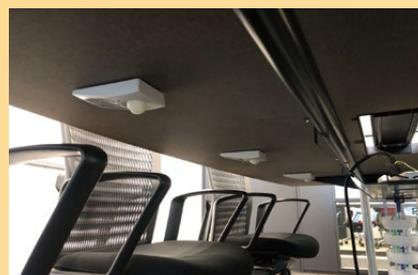
アンダーデスクセンサーを複数個設置時のイメージ (側面)
