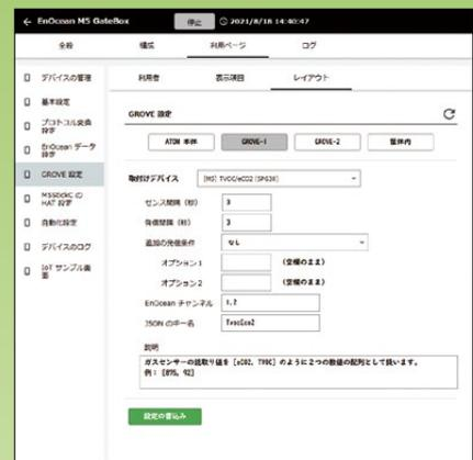
図 1. リモット・ステーションでのセンサユニットの設定
