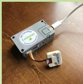
図 2. TVOC・eCO<sub>2</sub>ガスセンサユニット + EnOcean M5 GateBox
