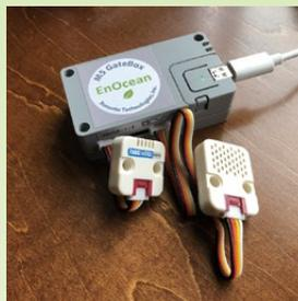
図 3. TVOC・eCO<sub>2</sub>ガスセンサユニット / 環境センサユニット + EnOcean M5 GateBox
