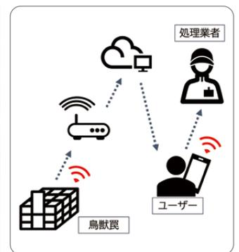
図11 鳥獣捕獲通知装置のシステムイメージ
