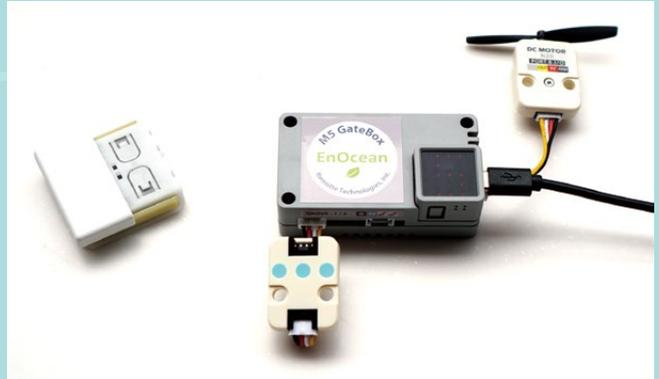
PTM 210Jの左右のスイッチを利用して、照明のオン・オフ切換えのみならず、色調や明るさを調整(長押しする)したり、ファンモーターの回転速度を制御する例
