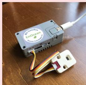
図3. ToF 距離センサユニット + EnOcean M5 GateBox
