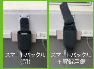
図 3. 宅配ボックスに装備されたスマートバックル
