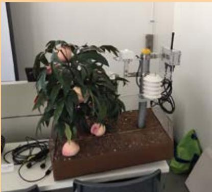
写真1 EnOcean Long Range 送信機 + センサー (温度・湿度 + 照度)
