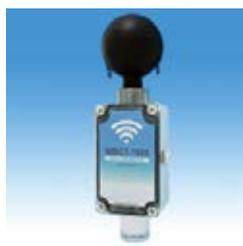
熱中症予防指針に暑さ指数を測定。エナジーハーベスのEnOceanを使用しているため、半透明のボックスに内蔵されたソーラー発電モジュールと単三電池を利用し、外部電源不要で使用可能。金属黒球を使用し、①気温、②湿度、③日射・輻射（ふくしゃ）など周辺の熱環境を測定。暑さ指数（WBGT）として送信距離100m、送信頻度10分で送信。指数規格 JIS B 7922 準拠。屋外でも使用可能な構造になっており、遊園地・学校・工事現場などの熱中症対策に。
