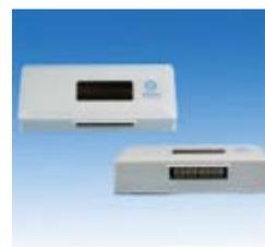
温度センサはPt1000ΩのA級とB級の2種類を用意し、高温仕様と低温仕様にて使い分けが可能です。ソーラーとコイン電池のハイブリッド電源で最大4chの温度計測が可能となり、ローコスト仕様となっています。HACCPで要求される冷蔵・冷凍庫の温度管理が1台で4ヶ所測定可能となりました。測定温度範囲は-40℃~+250℃のワイドレンジ（低温用は-40℃~+60℃）。
