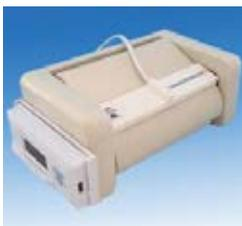
EnOceanを使用した無線通信でトイレトペーパーの交換、補充のタイミングをお知らせするセンサです。フラップの角度を検知することで、トイレトペーパーの残量が少なくなったことを知らせる信号を発信します。ソーラーとコイン電池のハイブリッドタイプのため、暗所でも使用可能です。
