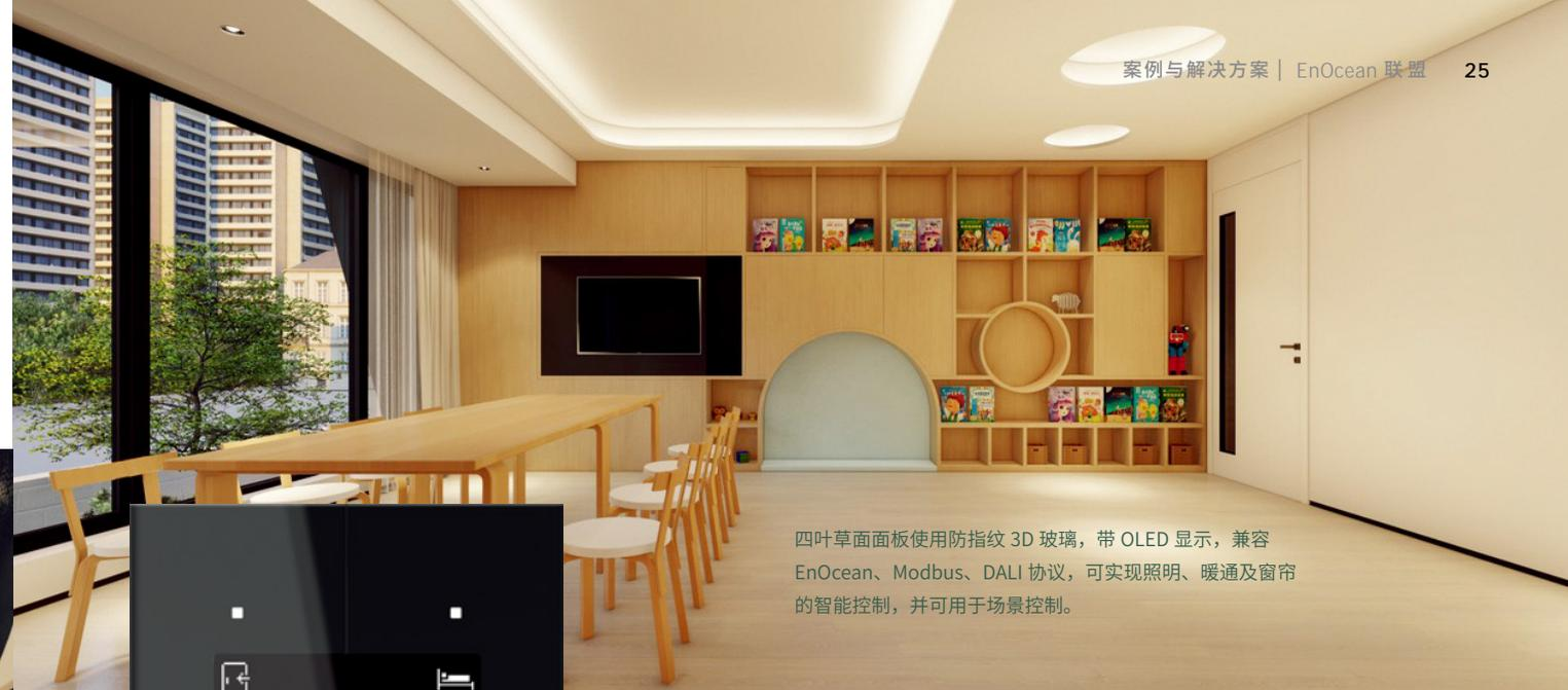
四叶草面板使用防指纹 3D 玻璃，带 OLED 显示，兼容 EnOcean、Modbus、DALI 协议，可实现照明、暖通及窗帘的智能控制，并可用于场景控制。
