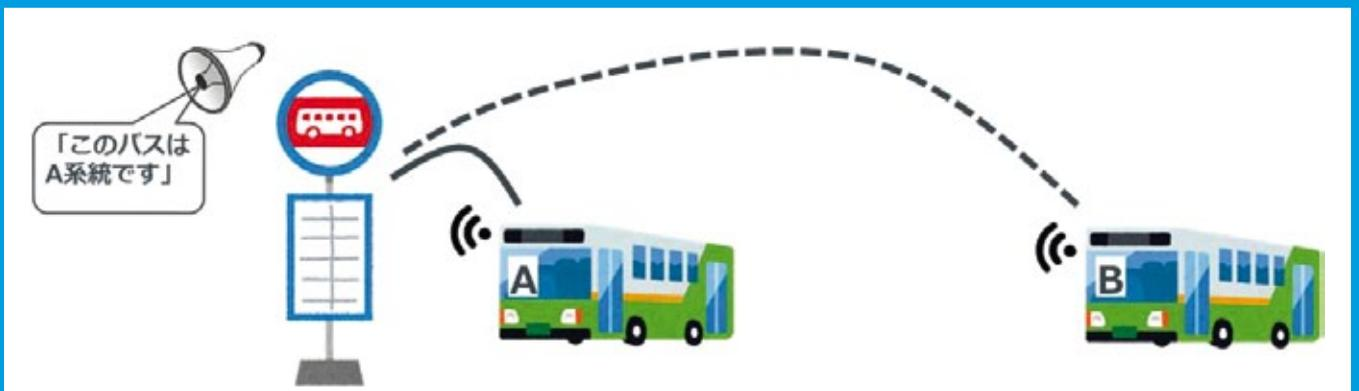
本システムの説明図。バスに設置した送信機から無線信号をバス停に設置した受信機で受信することで、バスの接近を検知・音声通知するシンプルな構造です。
