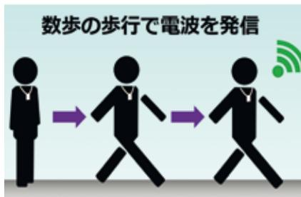
スター精密では、従来は無駄にしていた人間の運動エネルギーを電力に変えることが可能な小型の振動発電ユニットの開発を行っております。このたび、人が歩く際の振動を電源として、EnOcean無線規格の電波を発信する歩行用電池レスビーコン「EB10-E」を開発いたしました。
