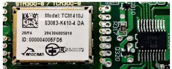
LEDバー内に実装されたEnOcean通信モジュールTCM 410J(写真)、ラピスセミコンダクタ社の調光制御信号出力機能付きマイコン(写真右)。
