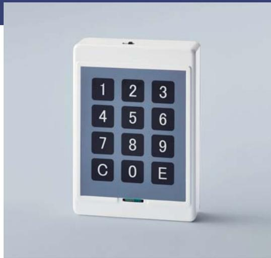
例えば、1-2-E-0-1-Eとして、「1-2-E」で12番目の装置を指定し、「0-1-E」でその装置をONさせるという風に使うことができます。多様な装置、照明などの複雑な制御をこのテンキー1台で行うことが可能となります。薄型であるため、壁や各種機器に貼り付ける方法で設置可能です。
