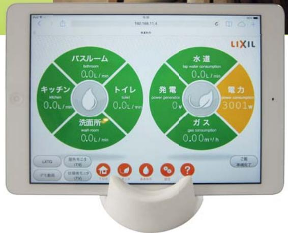
け閉めを自動的に行い、エアコンを使わなくても部屋を適切な室内温度や空調状況に保ちます。自己発電型のCTクランプは家のエネルギー消費を監視し、どこでエネルギーが節約できるかを指摘します。
