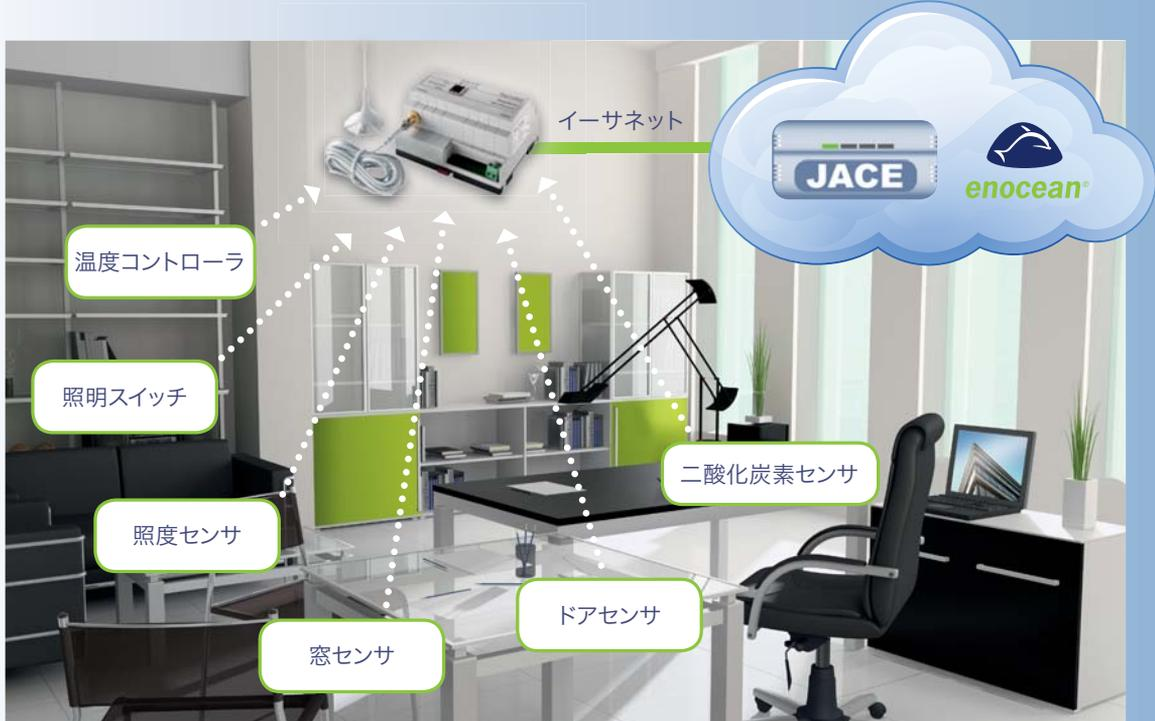
Niagara AX用のCNS-EnOceanイーサネットトランシーバドライバはNiagara AXとエネルギーハーベスティング無線ネットワークを基にしたウェブ技術プラットフォームです。第三者のコミショニングツールは必要としません。この完全に統合されたドライバにより、EnOceanデバイスの検出・帰属・管理が容易であり、Niagara AXの環境になれているシステムインテグレータはEnOceanベースのエネルギーハーベスティング無線通信デバイスを簡単に扱うことができます。
