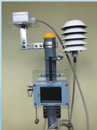
センサー側送信機接続例（温度 &amp; 湿度センサー，照度センサー）
