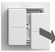
3. Lösen Sie mit Hilfe eines Schraubendrehers Gr. 1 das Funkmodul vorsichtig aus dem Gehäuse heraus.
