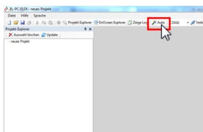
3. Die Software versucht nun über den EnOcean USB-Stick mit den BL-201 Verbindung aufzunehmen. Je nachdem, ob und wie viele DALI EVG bzw. Ballasts bereits an den/die BL-201 angeschlossen wurden kann dieser Vorgang bis zu ca. 30 Sekunden dauern.
