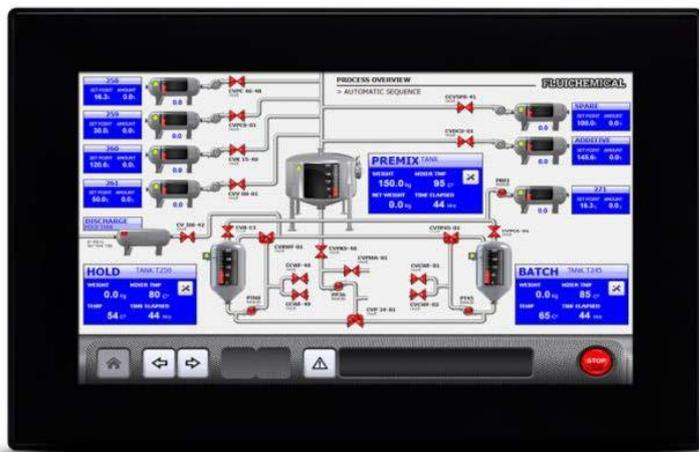
Das **VL-715 STYLE** ist ein beliebtes Bediengerät aus der hochwertigen SYTLE Serie mit kapazitivem Glastouch (Multi-Touch) und einer großen Anzahl an für die Automation erforderlichen Schnittstellen:
