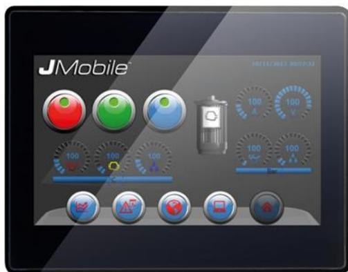
Das **VL-707 STYLE** ist das am häufigsten eingesetzte Bediengerät aus der hochwertigen SYTLE Serie mit kapazitivem Glastouch (Multi-Touch) und einer großen Anzahl an für die Automation erforderlichen Schnittstellen:
