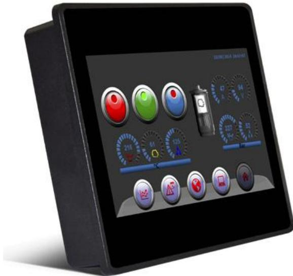
Das **VL-707 SMART** ist das perfekte Bediengerät mit allen für die Automation erforderlichen Schnittstellen: 1x **Ethernet** 10/100, 1x **USB** Host (2.0) sowie ein kombiniertes, **serielles Interface** (RS-232/RS-422/RS-485). Über den resistiven Folientouch und das helle 7" TFT mit 64K Farben lässt sich auf dem Gerät eine komfortable Bedienoberfläche realisieren.
