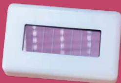
使用无需电池的EnOcean温湿度、CO<sub>2</sub>传感器，实现了免维护的建筑内监测和控制，同时确保能耗与成本的节约。
