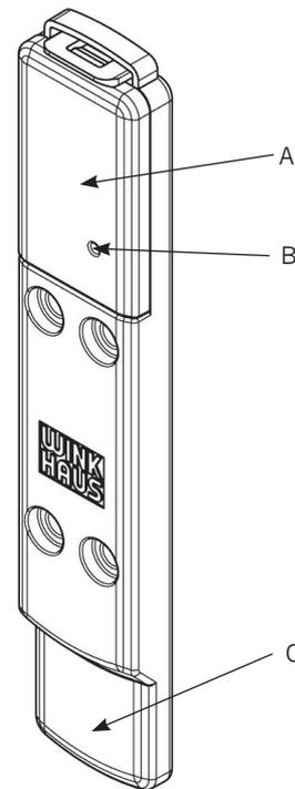
A = Batteriefach, B = Anlerntaste, C = Magnet-Kontaktfläche
