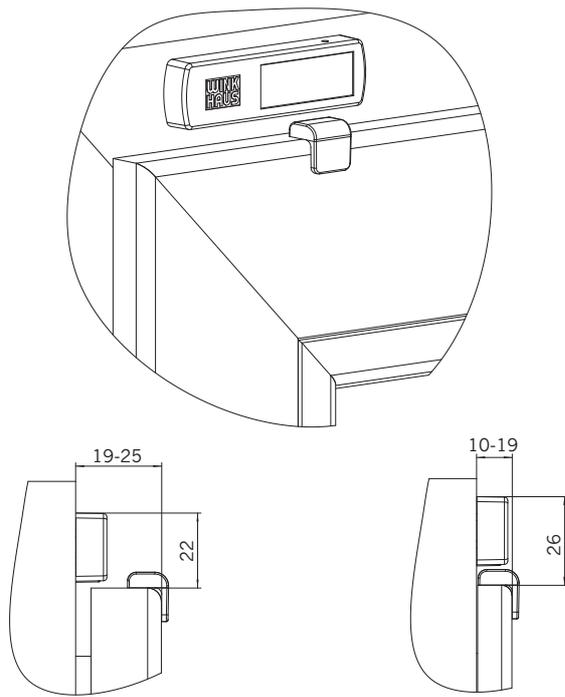
Sollte die Höhe des Flügelüberschlages kleiner 19mm sein (z.B. häufig bei Aluminiumfenstern), dann sollten Magnet und Funkkontakt so montiert werden, dass Magnet und Funkkontakt untereinander stehen. (dritte Abbildung)
