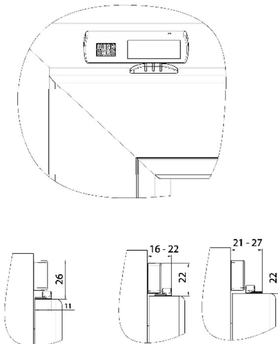
Sollte die Höhe des Flügelüberschlages größer als 19mm sein (z.B. häufig bei Kunststoff- und Holzfenstern), dann sollten Magnet und Funkkontakt so montiert werden, dass der Magnet vor dem Funkkontakt steht. (erste Abbildung)
