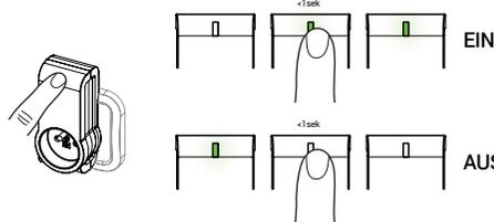
Der SmartPlug kann direkt ein- bzw. ausgeschaltet werden, indem der darauf befindliche Schalter betätigt wird. Wenn die LED des SmartPlug grün aufleuchtet, bedeutet dies, dass Ihr Gerät eingeschaltet ist. Wenn die LED aus ist, ist die Stromversorgung zu Ihrem Gerät unterbrochen.
