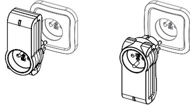
Mithilfe ein innovatives Designs, kann der SmartPlug in beiden Richtungen an einer Steckdose angeschlossen werden, entweder nach oben oder unten zeigend.
