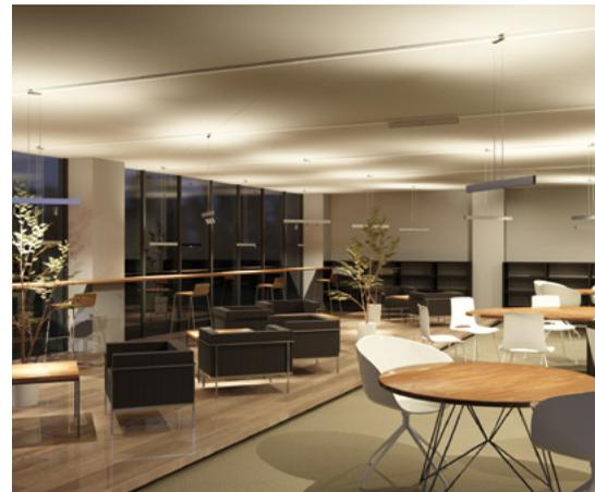
またLEDは光の直進性が強く、眩しさが欠点だが、最大40度角で見上げても眩しくないように光学制御しました。
