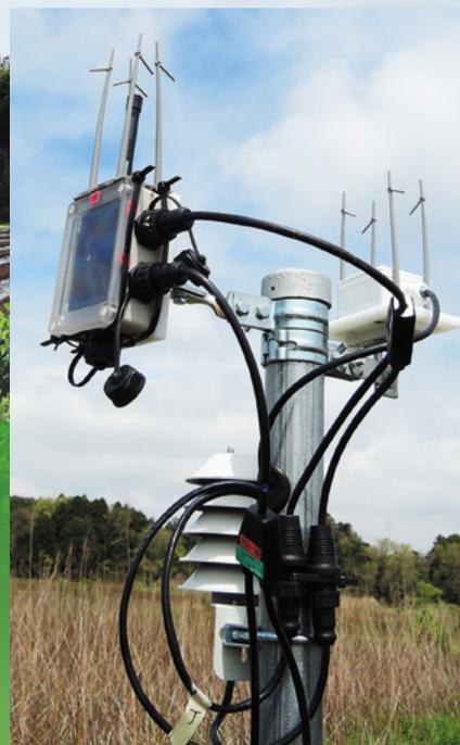
そのほか、ゲートウェイトランシーバーにはリピーター機能も保持しており、センサー・トランシーバーから受信したデータをさらに数km離れたゲートウェイトランシーバーに転送することも可能です。センサー・トランシーバーとゲートウェイトランシーバー間の通信は片方向のほか、双方向通信にも対応できます。
