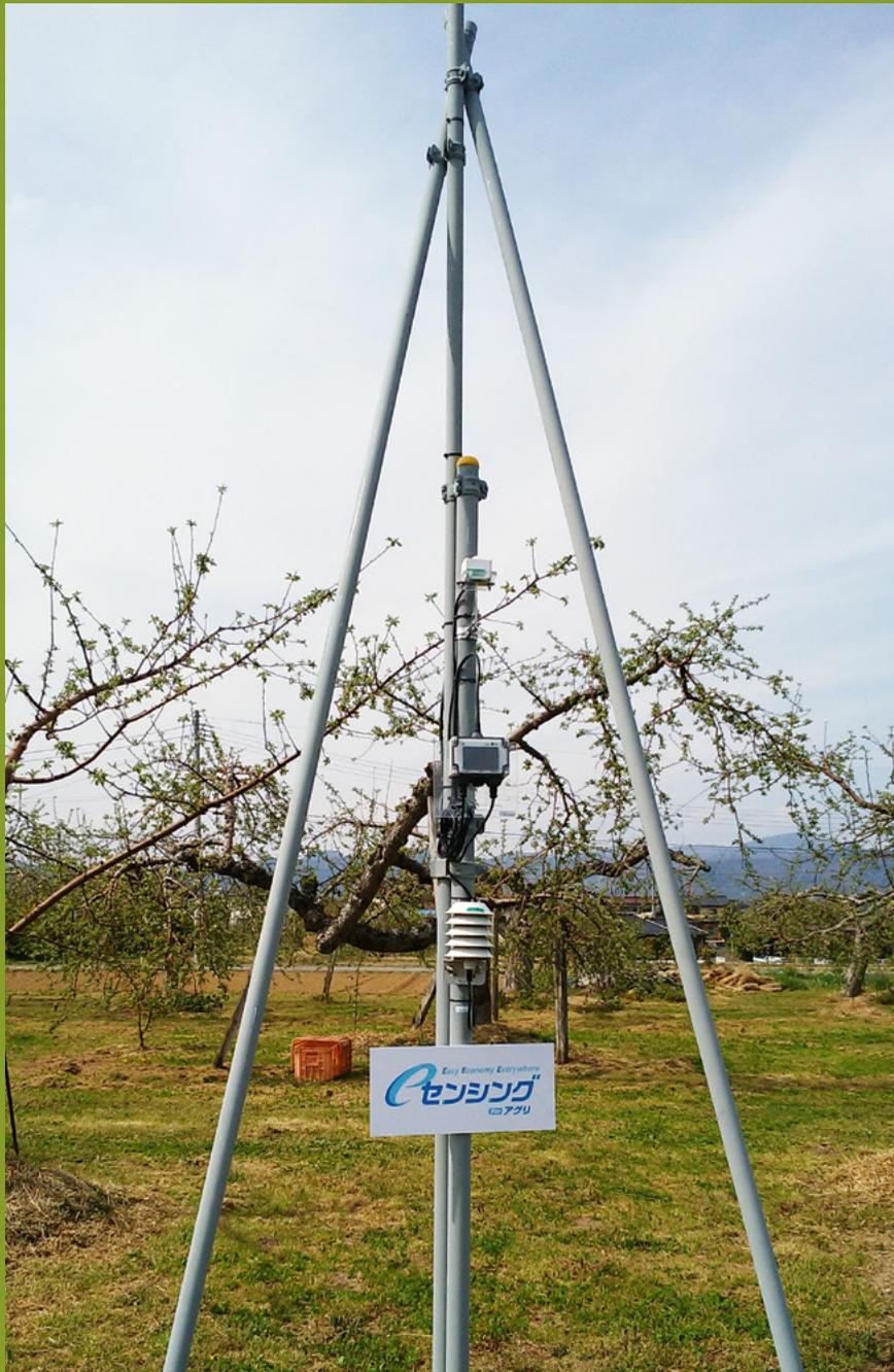
「eセンシングForアグリ」は、EnOcean Long Range対応のセンサーを圃場に設置し、「温度」「湿度」「照度」等のデータをNTT東日本が提供するオンラインストレージサービス「フレッツ・あずけ〜る」に自動収集することで、スマートフォンアプリやパソコンなどを用いて圃場環境を“見える化”するソリューションです。
