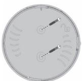
3. Drehen (Bajonettverschluss) Sie den Funk-Montagesockel ASD 10 (A) auf die Abdeckung/Halter.
